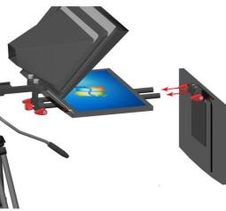
(五)、自检屏背后的两个孔穿进液晶显示屏支架的两根支架，并扭动可调螺丝进行固定。
