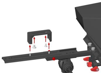
(六)、摄像机增高架放置在摄像机滑道上方，用两个细螺丝固定两端相对应的位置，上图中间螺丝固定摄像机。 〈6〉
