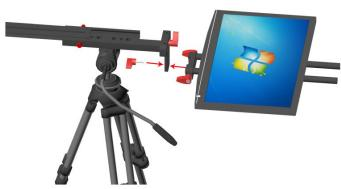
(三)、将液晶显示屏背面的两个孔分别穿进液晶显示屏支架的两个支架上面用可调螺丝将液晶显示屏固定在液晶显示屏支架，并将液晶显示屏支架固定在支架连接最下面一个孔。
